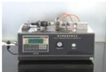
锁具拔插旋钮测试机
