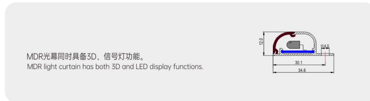
MDR 型截面图 IP54 MDR Section
