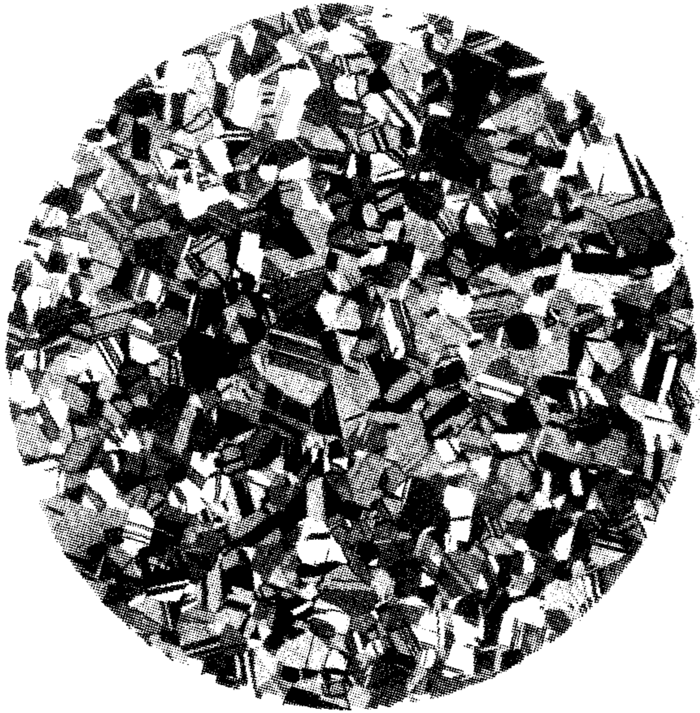
晶粒平均直径 0.030 mm (75×0.035 mm)
