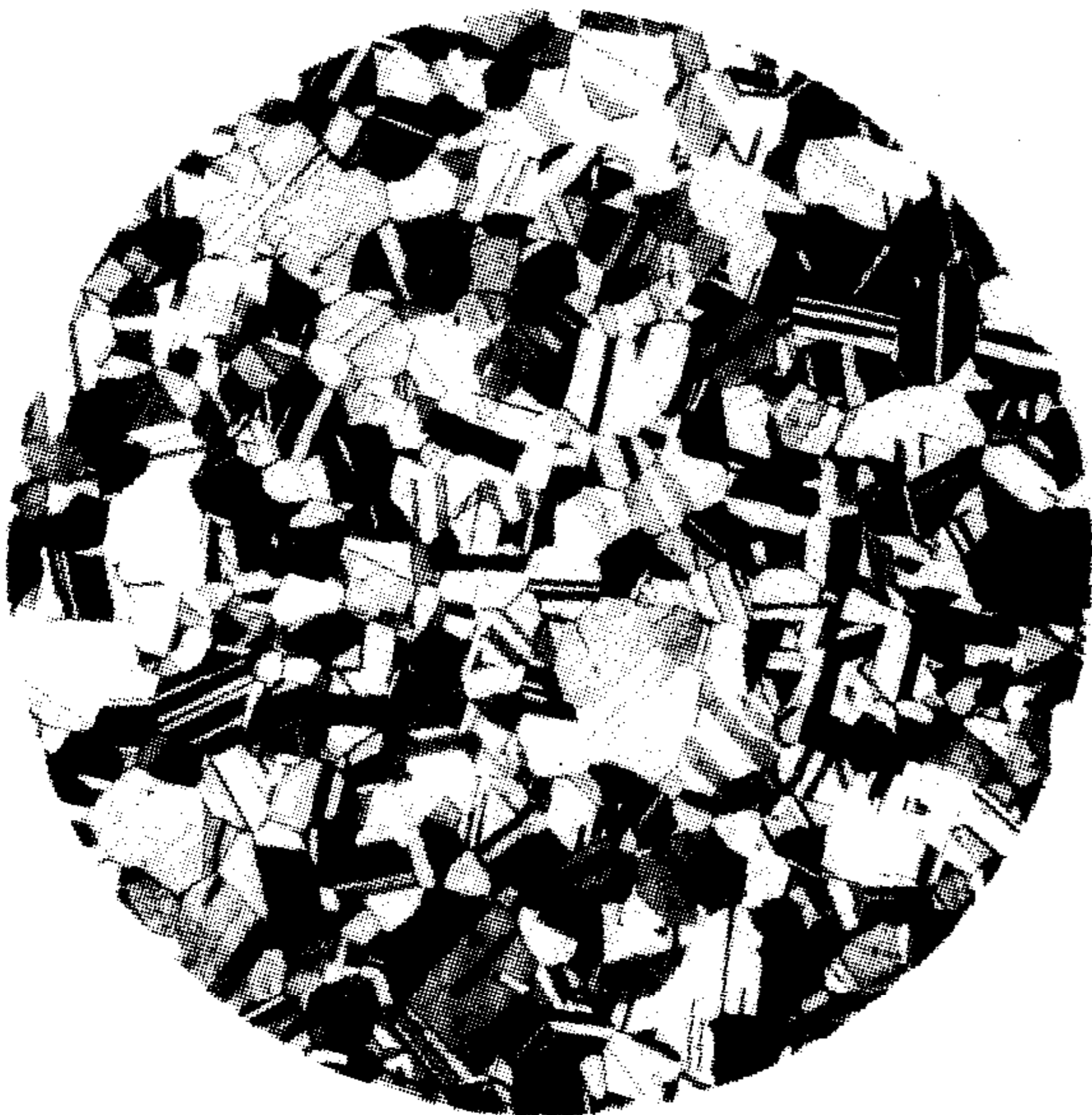
晶粒平均直径 0.040 mm (75×0.050 mm)
