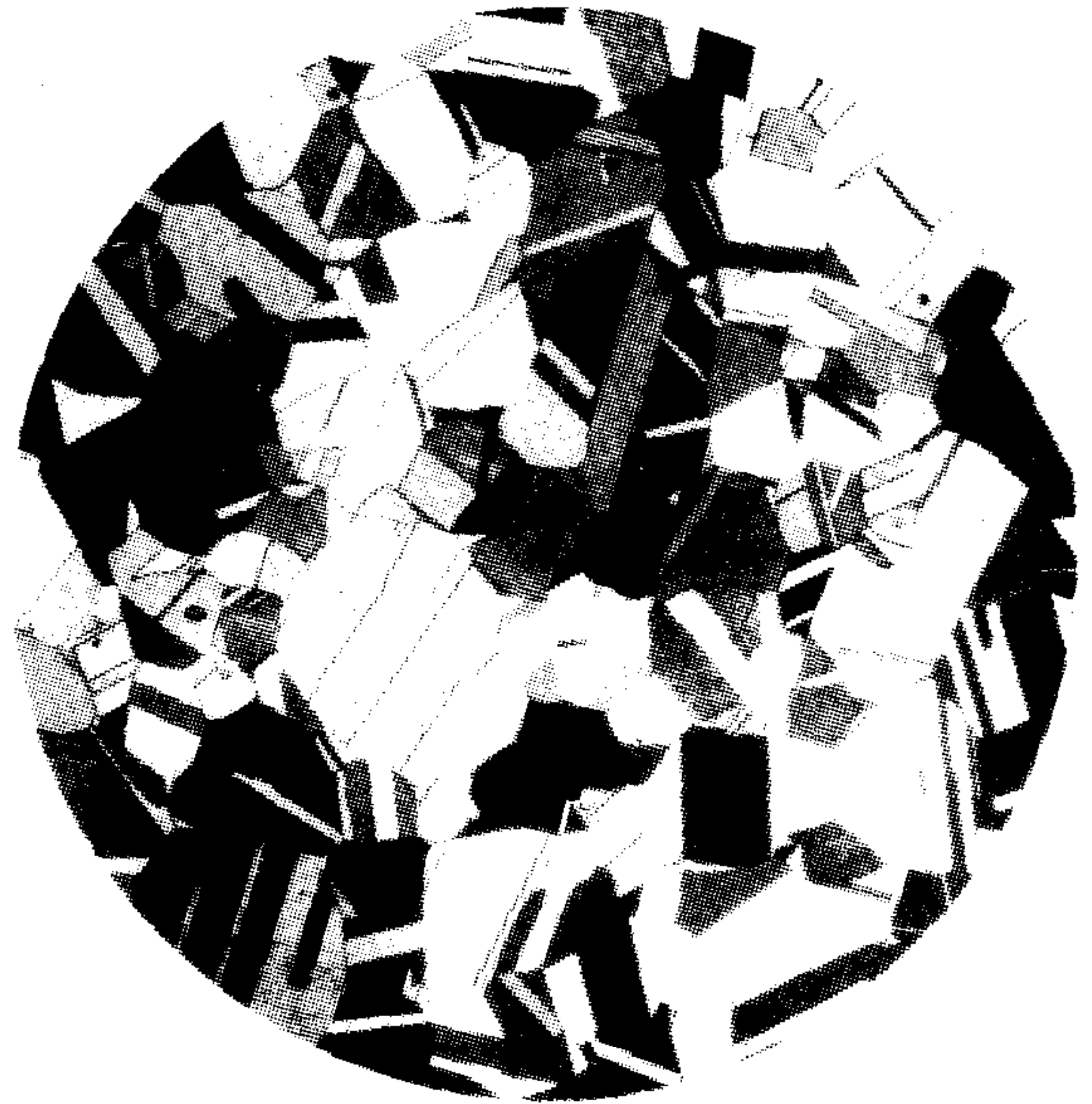
晶粒平均直径 0.075 mm (75×0.100 mm)
